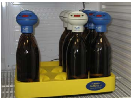
Abbildung 12: Sicht in den offenen Thermoschrank mit Rührer
