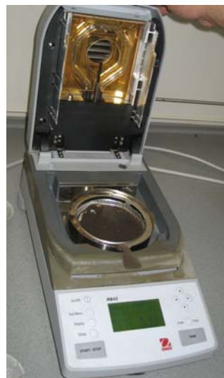
Abbildung 4: Trocknen und wiegen des Filters
